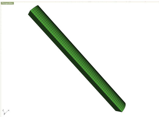
圖九、Moldex3D-Mesh 產生 Taylor bar 1/4 簡化模型之網格
